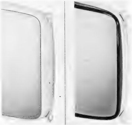
Der schmale Metallrahmen der Selbond -Bildröhre (rechts) im Vergleich zur Bildröhre A 59-12 W (links)
