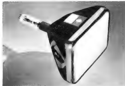
Die Telefunken-Elektronenstrahlröhre M 17-11 besitzt einen rechteckigen Schirm mit einer ausnutzbaren Fläche von 9,5 cm \times 12,5 cm
